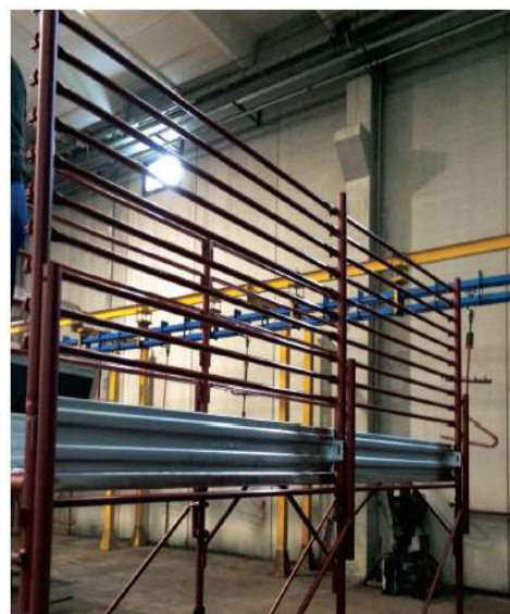
Figura 5.1.1-2 - Esempio di prototipo di parapetto di sommità a perni
