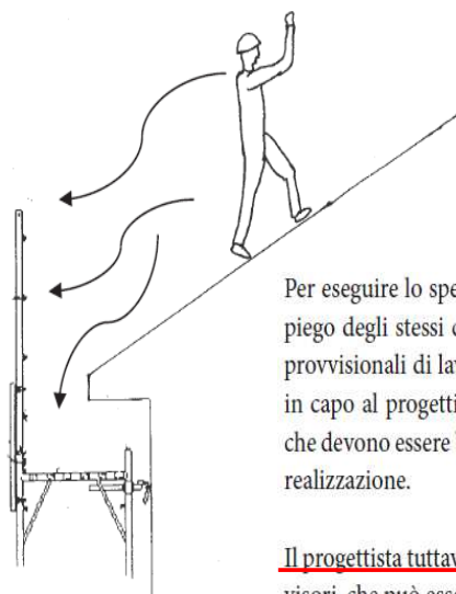
Figura 5.1.2-1 - Lavoratore in caduta lungo il pendio di una copertura [Fab-015]
