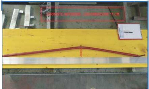
Figura 15 - Deformazione dopo l'impatto del corrente inferiore
